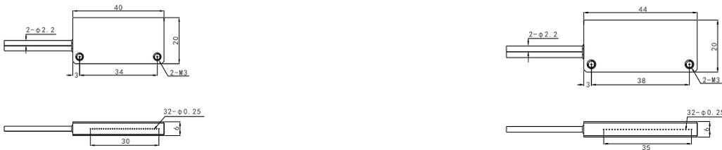
DS-FAD13 反射型 自由切割 DS-FAD14 反射型 自由切割
