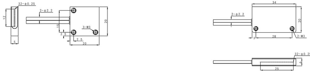
DS-FAD11 反射型 自由切割 DS-FAD12 反射型 自由切割
